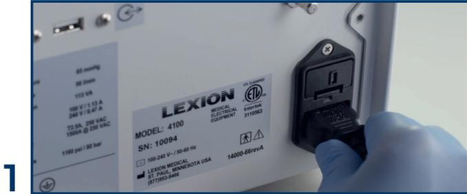
**1** Stecken Sie das mitgelieferte Netzkabel in eine geerdete Steckdose und das andere Ende in die Buchse auf der Rückseite des Insufflators.
