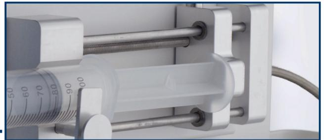
**4** Drücken Sie den Knopf der verstellbaren Klemme und schieben Sie diese zurück, so dass der Spritzenkolben vollständig aufliegt. Sichern Sie die Spritze mit der Klemme.
