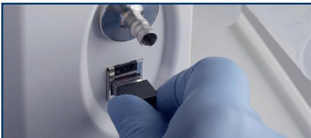
**5** Stecken Sie den Data Link des Insuflow-Ports in die entsprechende Buchse des Insufflators.
